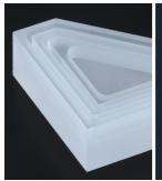
幅7mm深さ10mmの止まり溝加工
